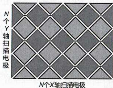
图4-3 分别测量行和列感应单元自电容
