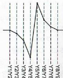
Y5和GND短路,所有X电极都lift
