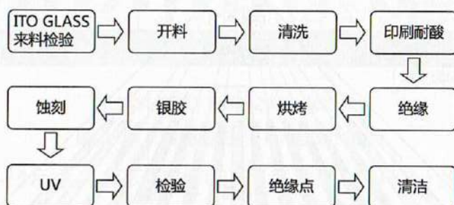
图3-12 GLASS的生产流程图
